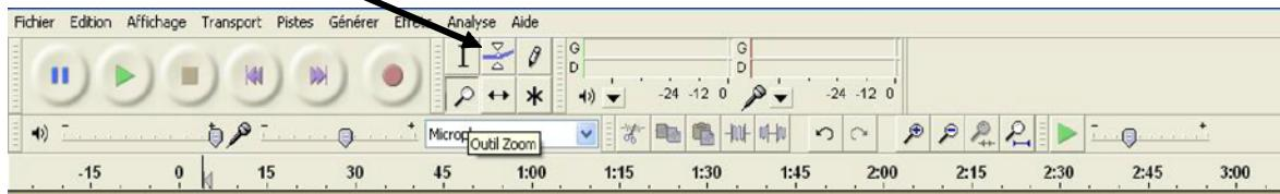
Il est possible de dilater l'échelle verticale en plaçant la souris sur la partie gauche de l'enregistrement
